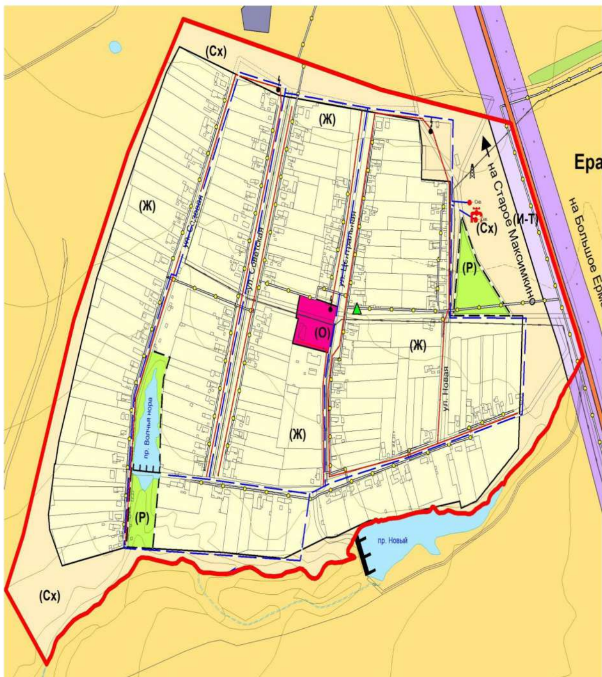
Рисунок 24- Планы перспективных и существующих водопроводных сетей к потребителям воды в селе Ерандаево.
