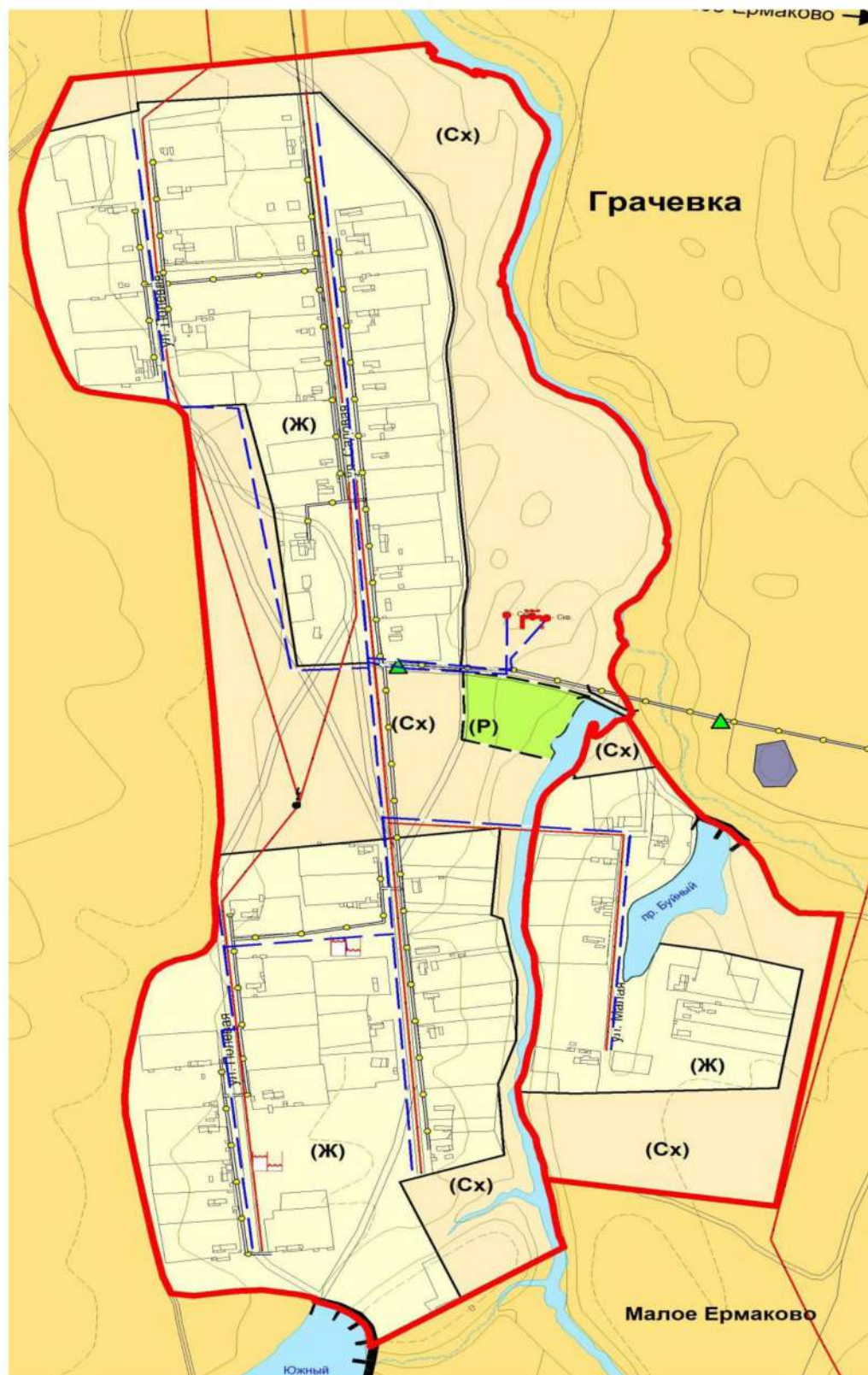
Рисунок 25- Планы перспективных и существующих водопроводных сетей к потребителям воды в деревне Грачевка.
