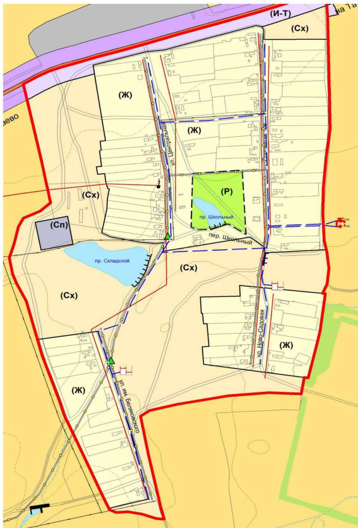
Рисунок 26- Планы перспективных и существующих водопроводных сетей к потребителям воды в деревне Андреевка.
