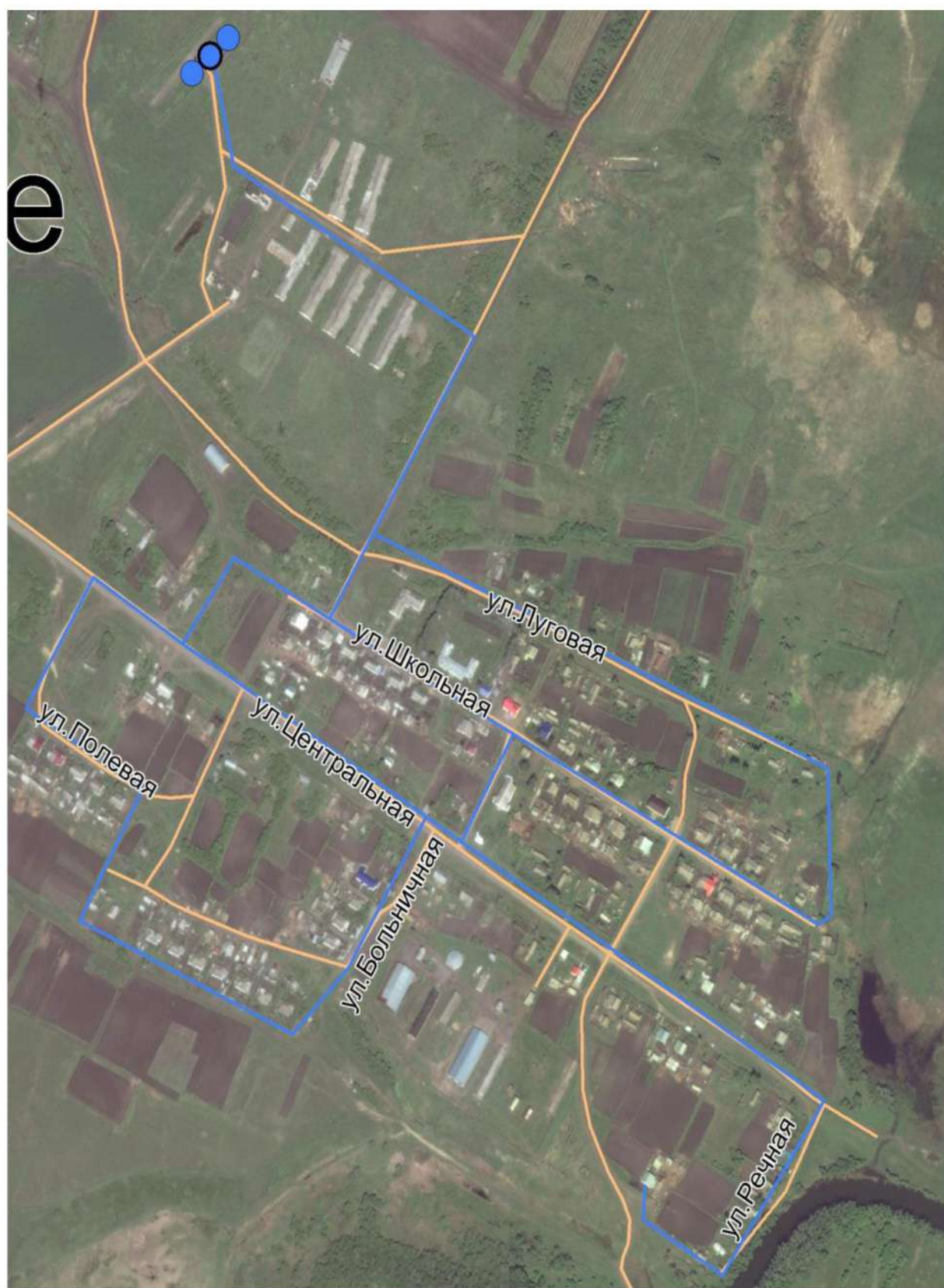
Рис. № 15- Схема водоснабжения села Залесье
