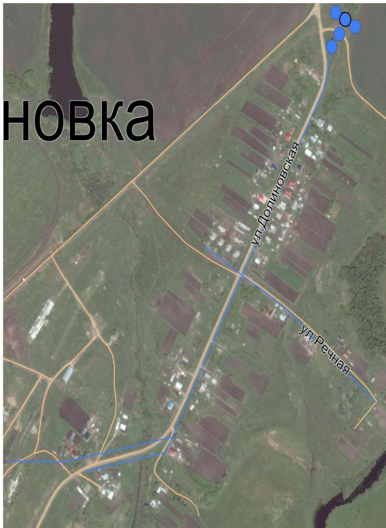
Рис. № 5 - Схема водоснабжения деревни Долиновка
